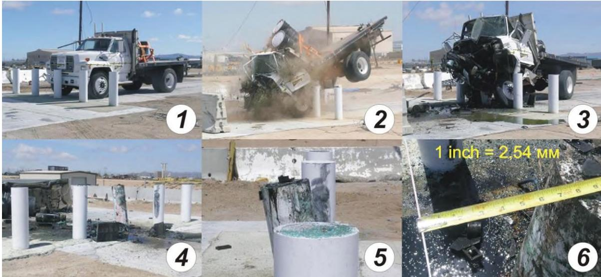
**Рис. 2 – Оценка прочности конструкции ограждения по методу К8**
